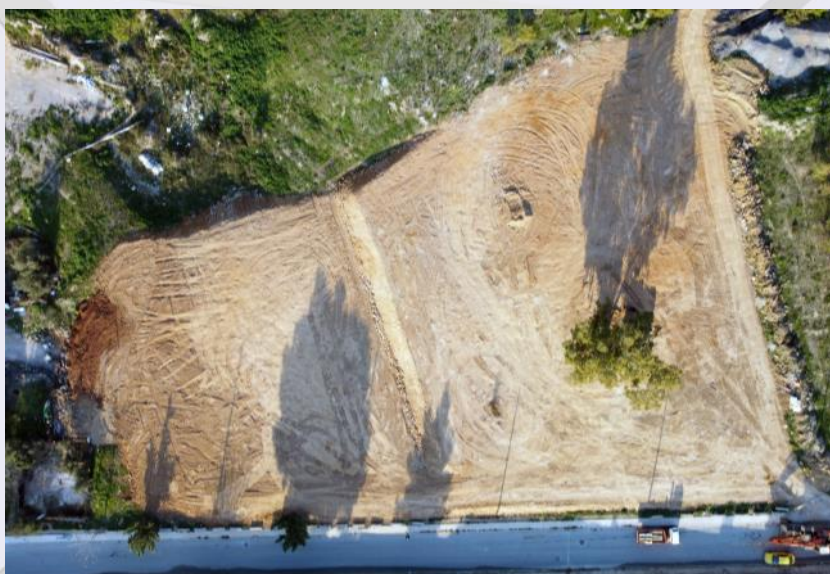
Διαμόρφωση εδάφους για την έδραση εργοταξιακών κεντρικών γραφείων της Αναδόχου Κοινοπραξίας.
